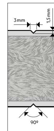
Detail drážky „V“ dveří Element
