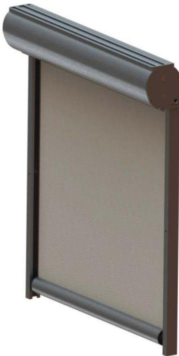
Roleta byla navržena pro použití ve vnitřních i venkovních instalacích. Motor je chráněn proti vlhkosti, třída krytí IP44. **Roleta není určena pro použití v prostředích s nebezpečím výbuchu.** Obslužný spínač by měl být umístěn v interiéru. Je možno jej umístit venku, avšak pouze s odpovídající ochranou zabraňující proniknutí vody a chránící všechny elektrické součásti.
