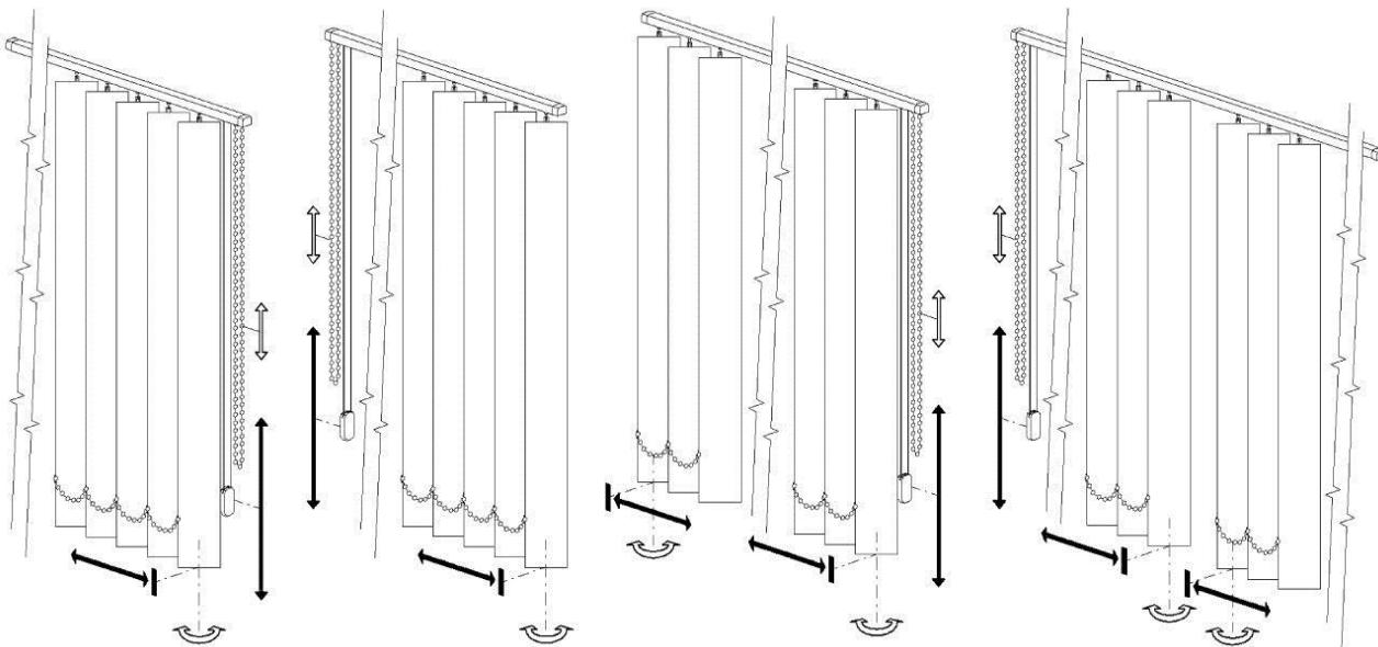
stahování k ovládání / stahování od ovládání / stahování opona ke krajům / stahování opona do středu
