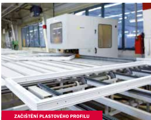
ZAČIŠTĚNÍ PLASTOVÉHO PROFILU
