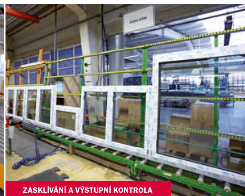
ZASKLÍVÁNÍ A VÝSTUPNÍ KONTROLA
