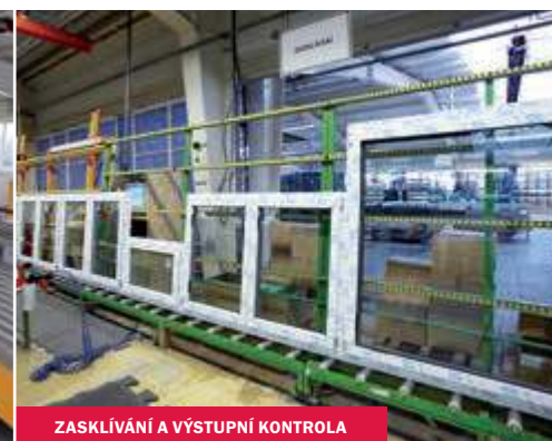
ZASKLÍVÁNÍ A VÝSTUPNÍ KONTROLA
